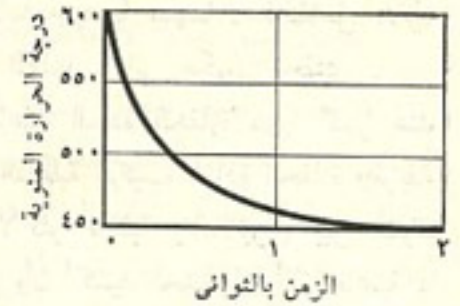
شكل ٧ : النظام الحراري الأمثل لأكسدة SO_2
