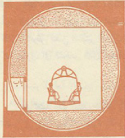
شكل ٣١: الرسم التخطيطي لتركيب «ارجوحة الشيطان» .
