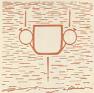
شكل ٥٠ : الطريقة التي تم بواسطتها رفع محطمة الجليد «سادكو» . وبين الشكل المقطع العرضي لمحطمة الجليد والعوامات وسلاسل الرفع .
