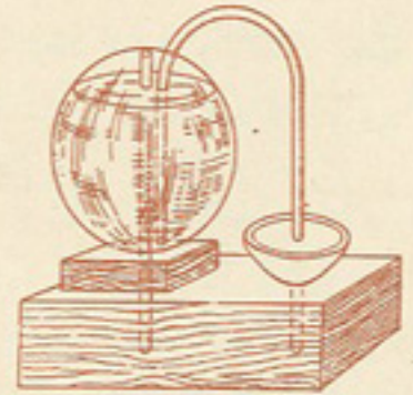
شكل ٨٣ : الترموسكوب (المكشاف الحرارى) الذى اخترعه هيرون الاسكندري .
