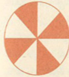
شكل ١٤٤ : قرص يستخدم لتعيين سرعة دوران المحرك .
