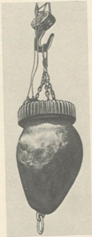
شكل ٩٣ : ونش مغناطيسى كهربائى يحمل كتلة حديدية هائلة .
