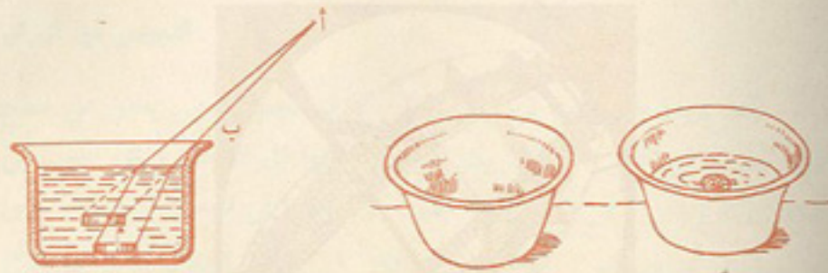
شكل ١١٢ : تجربة قطعة النقود الموضوعة في الفئجان . شكل ١١٣ : السبب الذي يجعل قطعة النقود اسيئة في الشكل ١١٢ ، تبدو في موضع اعل من موضعها الحقيقي .
