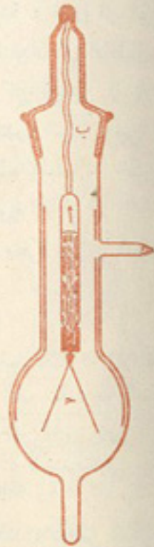
شكل ٩٨ : ساعة راديومية يمكن اعتبارها «دائمة الحركة» تقريبا حيث يمكنها ان تعمل لمدة ١٦٠٠ سنة .
